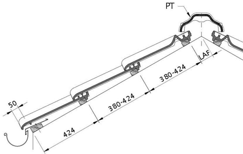
Zeichnung TITANIA Dachquerschnitt DQF
