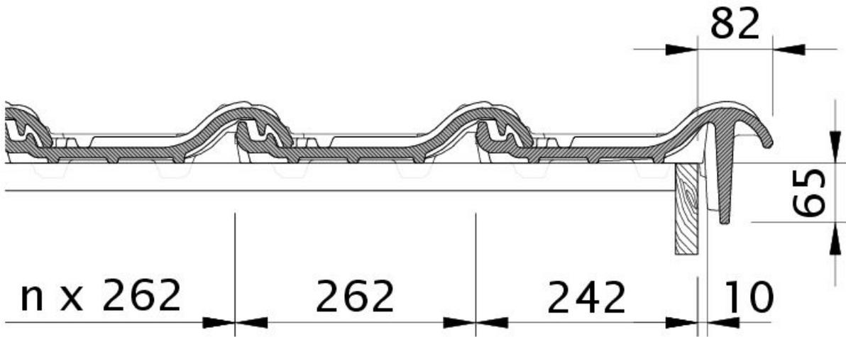
Zeichnung TITANIA Ortgangziegel rechts mit Ortgangbrett OBR
