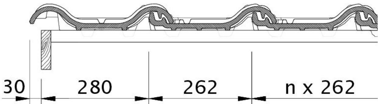
Zeichnung TITANIA Ortgang links mit Ortgangblech und Doppelwulst ODL
